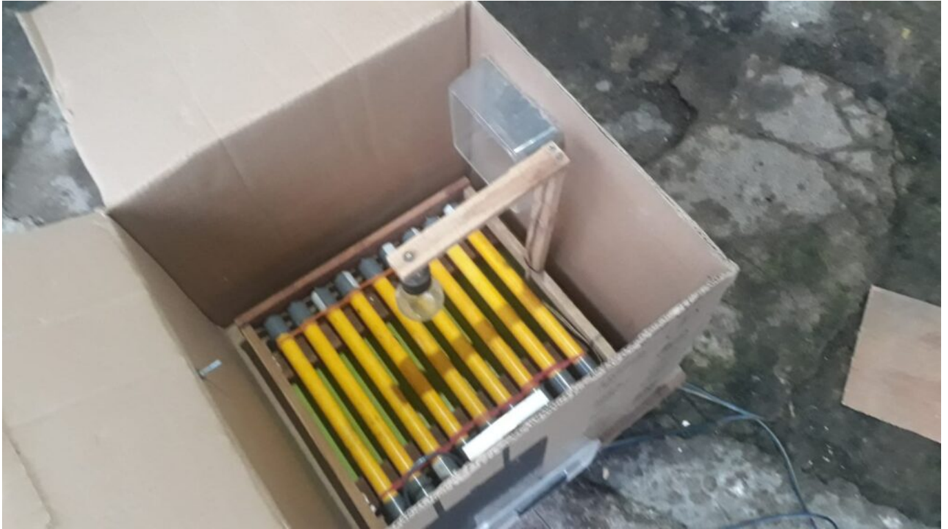
Penataan Lampu Pijar dan rak Pemutar dalam Box Kardus
